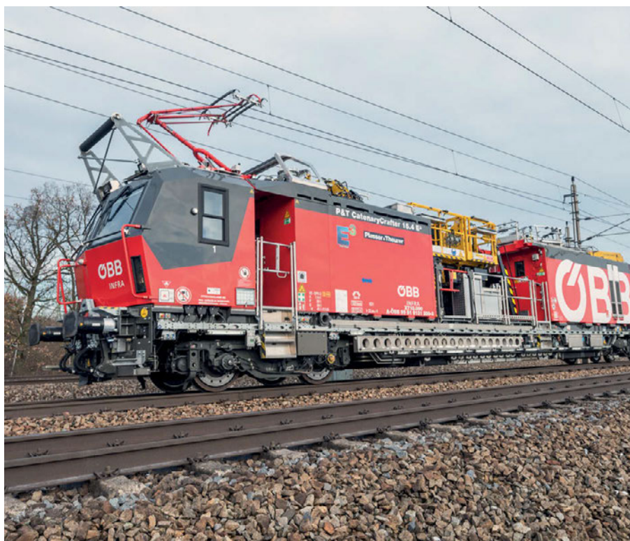
5: Plasser CatenaryCrafter 15.4 E 3 bei Streckenfahrt mittels Oberleitung
