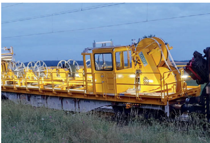
Fahrzeug zur Fahrleitungsmontage
