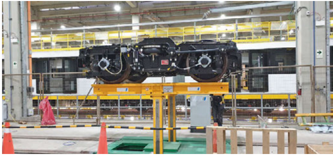
5: Unterflur-Drehgestell-Hebestände in Peru
