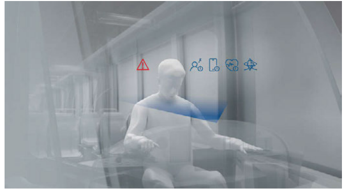
7: Der Tram Focus Assist analysiert die Blickrichtung, Mimik und Haltung des Fahrers und erkennt Müdigkeitssignale oder Ablenkung vom Verkehrsgeschehen und warnt den Fahrer entsprechend
