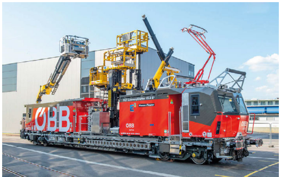
3: Arbeitsaggregate des CatenaryCrafter in ausgefahrenem Zustand
