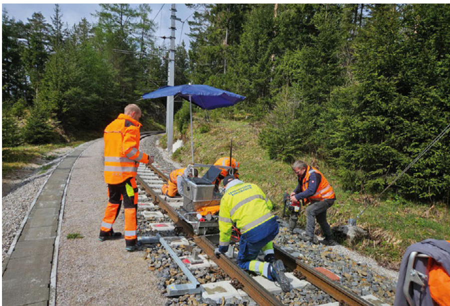
Querverschiebewiderstandsmessungen des Teams der Universität Innsbruck bei der Mariazellerbahn
