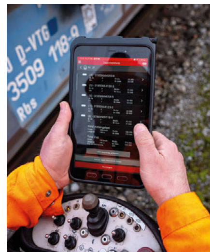
4: Einsatz der mobilen Anwendung Willy bei der Erfassung vom Bremsdaten Quelle: Daniel Hänni
