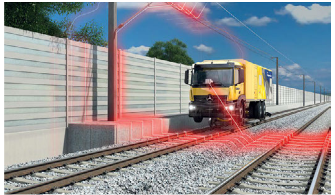
Der InfraSpector Truck nimmt Messungen an Fahrweg, Schiene, Weiche und Oberleitung vor Quelle: Plasser & Theurer
