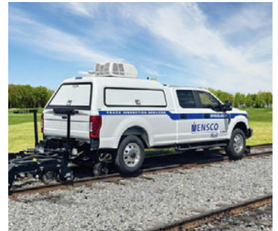
Gleisinspektionstechnik von Ensco an einem Zwei-Wege-Fahrzeug Quelle: Ensco
