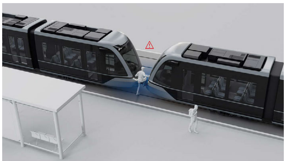
5: Der Tram Near Range Assist überwacht den Nahbereich
