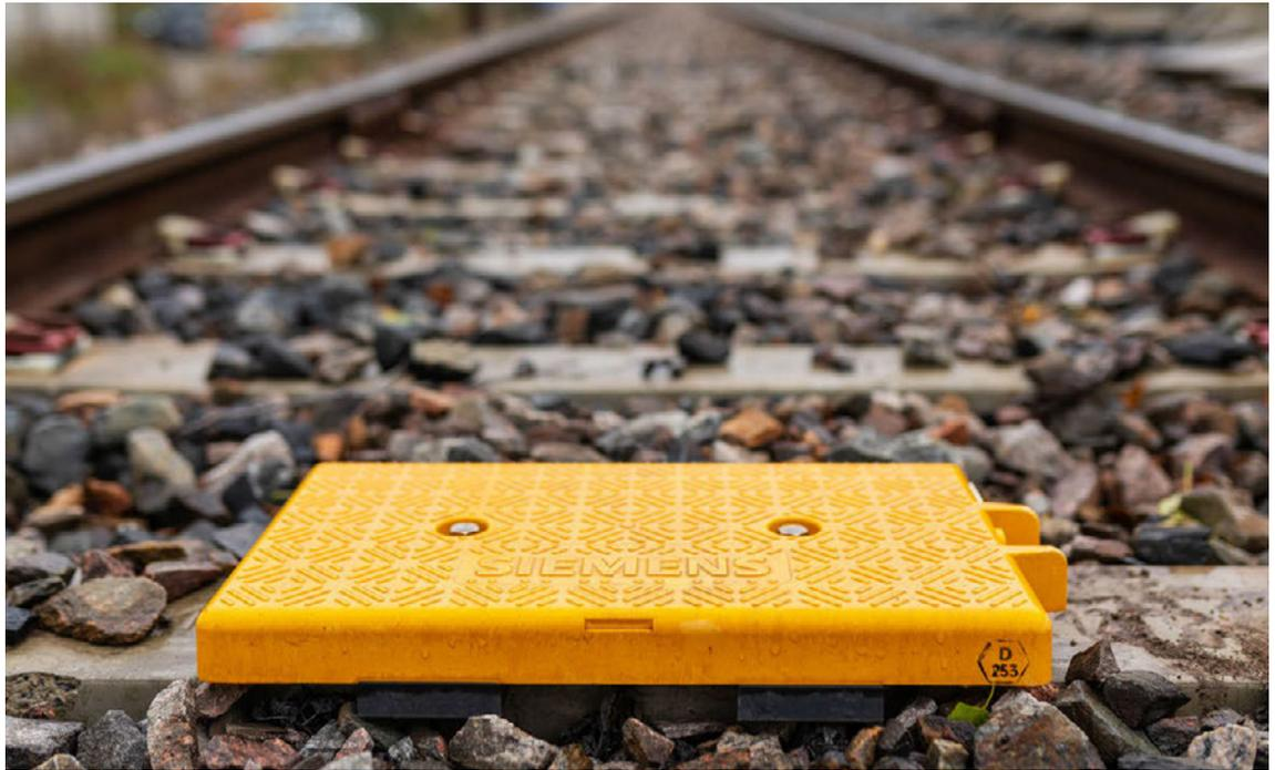
trem hoher Zuverlässigkeit übertragen werden müssen. Fehlt diese Information, wird der Zug nach einer definierten Zeit gestoppt.
