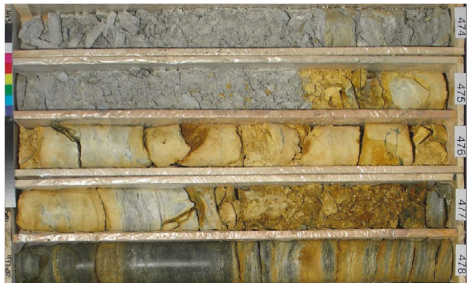
2: Trias an der Basis der Flatschspitzdecke: Rauhwacke sowie rauhwackoid angelöster Dolomitmarmor (gelb) und Chloritphyllit (grünlich) an der Basis der Triasabfolge in der Bohrung Gr-B-01/04 (473-478m Bohrteufe) Quelle: BBT SE
