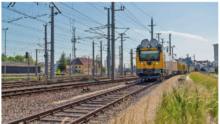
Die Fahrzeugtests werden in den Bereichen Fahrtechnik, Stromabnehmer, Akustik und Bremsen durchgeführt
