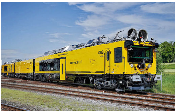
1: Stadler wird 18 der multifunktionalen und emissionsarmen Lösch- und Rettungstriebzüge an die ÖBB-Infrastruktur AG liefern. Diese werden als „Servicejets“ an verschiedenen Tunnelportalen stationiert und gemeinsam mit den Feuerwehren vor Ort zum Einsatz gebracht Quelle: ÖBB / Stadler
