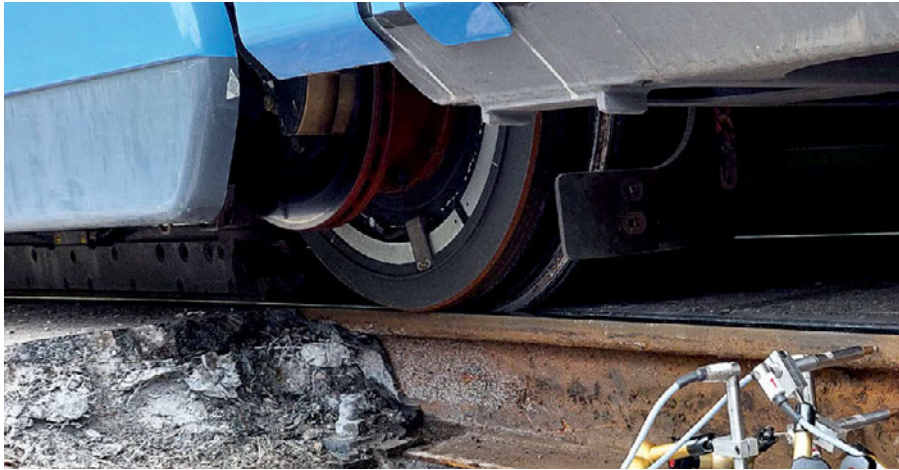
4: Messung während der Überfahrt einer Straßenbahn auf einem Oberbau mit Eindeckung*. *): An der Messstelle wurde die Fahrbahn freigelegt. Die Freilegung ist jedoch auf eine kurze Länge beschränkt, so dass sie kaum Einfluss auf die Wirkungsweise des Systems hat.
