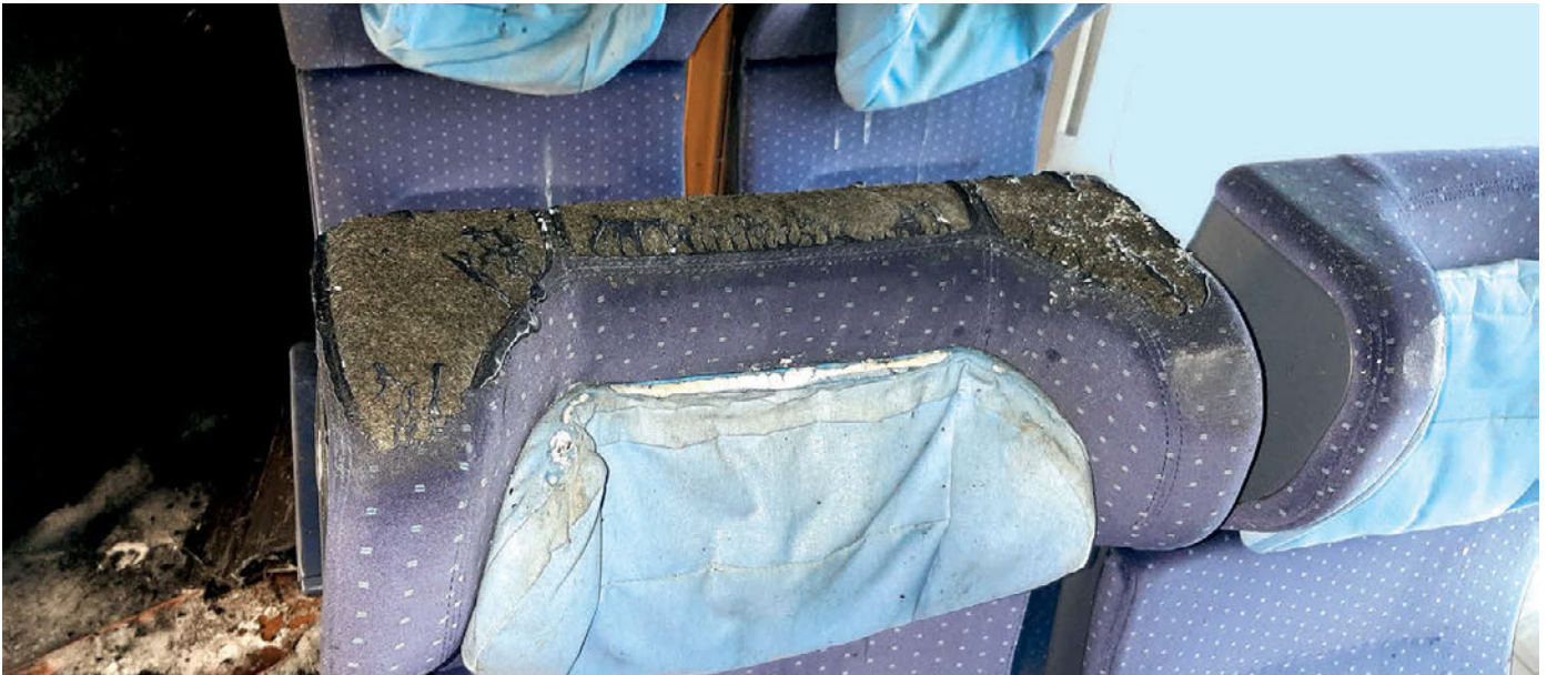
Abb. 1: Ausschließlicher, jedoch enormer Sachschaden infolge eines Fahrzeugbrandes mit technischer Ursache
