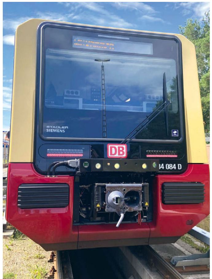
S-Bahnzug mit den Kameras (im Führerstand) und den LiDAR (an der Front) Quelle: Siemens
