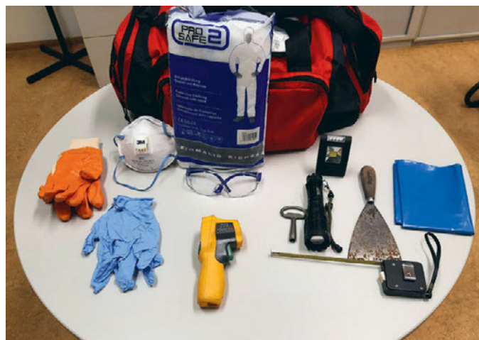
Abb. 3: Ausrüstung für Brandschadensbegehungen
