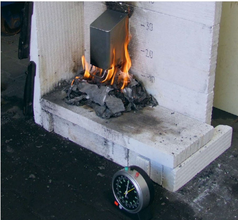
Abb. 4: Nachstellung einer Zündattacke zwecks Befundung einer möglichen vorsätzlichen Brandstiftung im WC-Bereich
