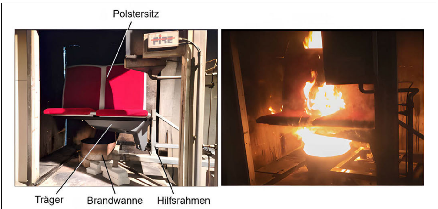
Abb. 5: Brandversuch mit Polstersitz. Versuchsaufbau und Brand nach 600 s
