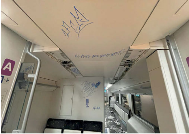
Auf diesem Bild deutlich zu sehen: Verkleidung wurde von der Decke gerissen.
